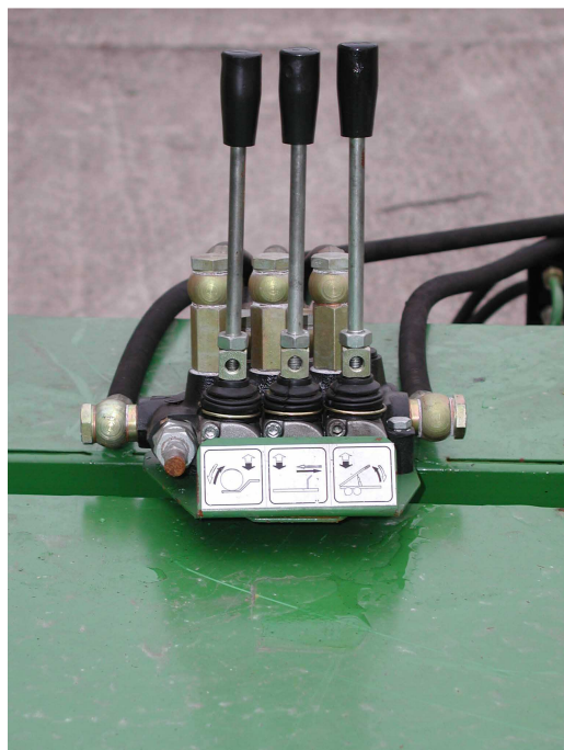
Rys.20 POŁOŻENIE PIKTOGRAMU OBJAŚNIAJĄCEGO FUNKCJE ROZDZIELACZA HYDRAULICZNEGO
